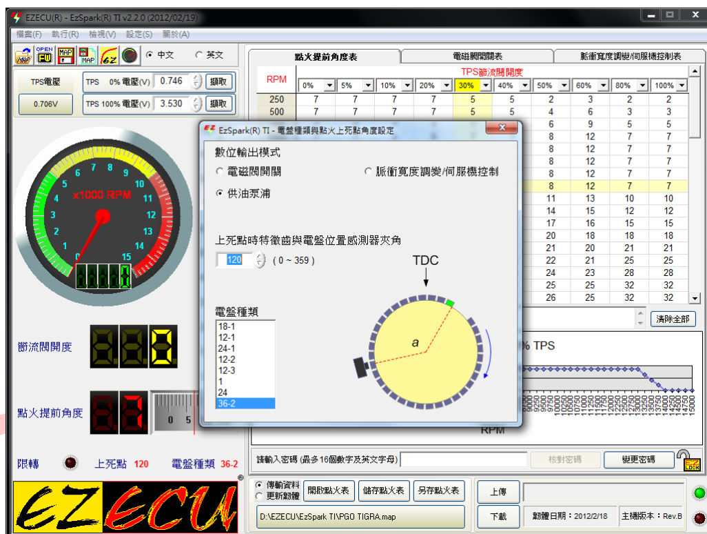
圖 3-10 電盤種類與點火上死點角度設定畫面
