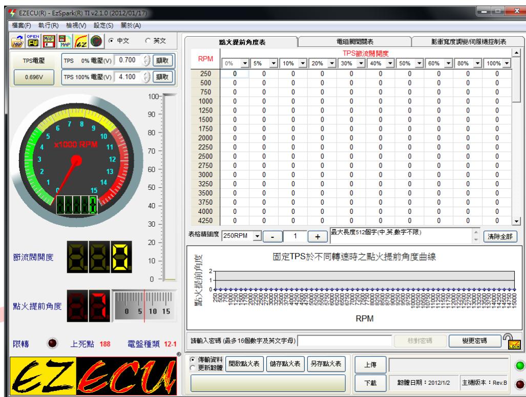
圖 3-2 EzSpark® TI ECU 應用軟體操作畫面 (尚未設定密碼且已連線)
