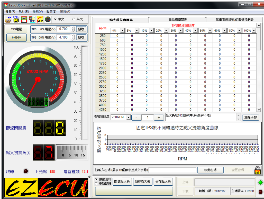
圖 3-3 EzSpark® TI ECU 應用軟體操作畫面 (已設定密碼且已連線)
